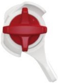
Регулировка отскока Контролирует уровень скорости отскока амортизатора после сжатия
